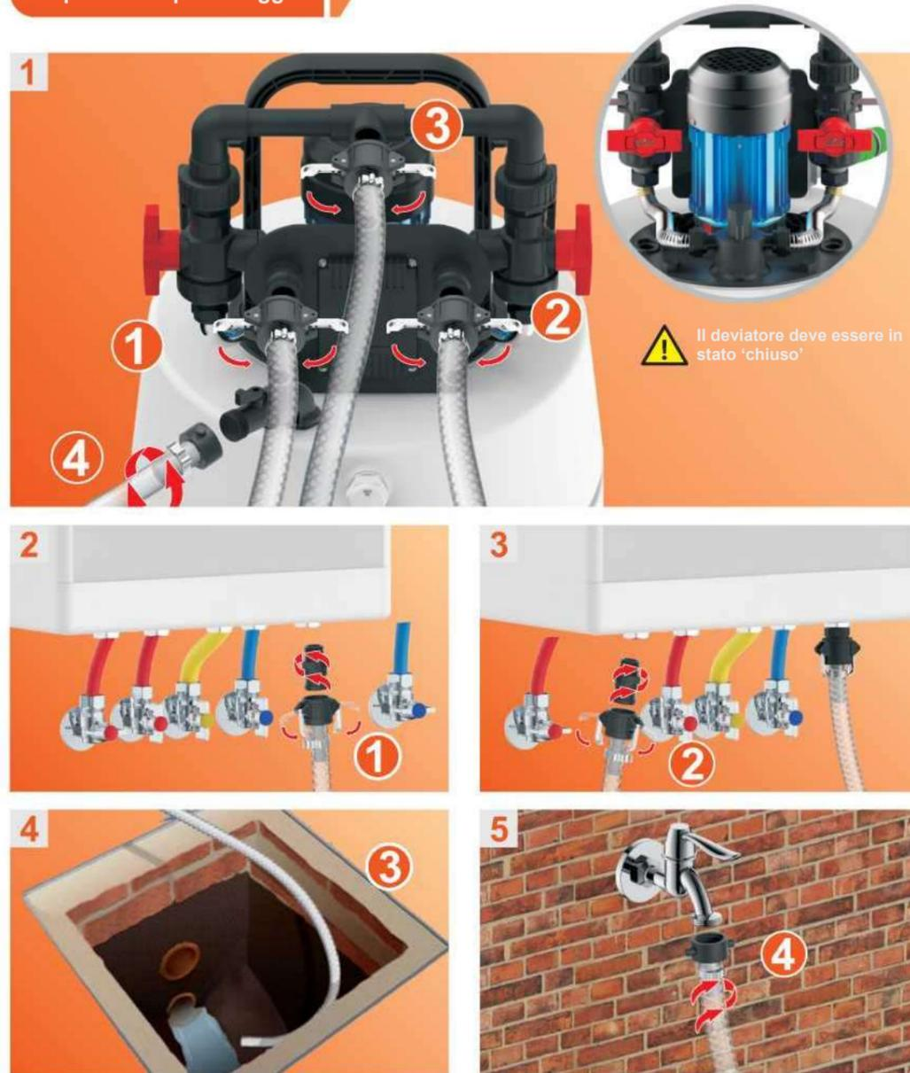
1. Collegare i tubi di circolazione, il tubo di scarico, il tubo di ingresso acqua ai fori indicati della pompa per lavaggio impianti;
