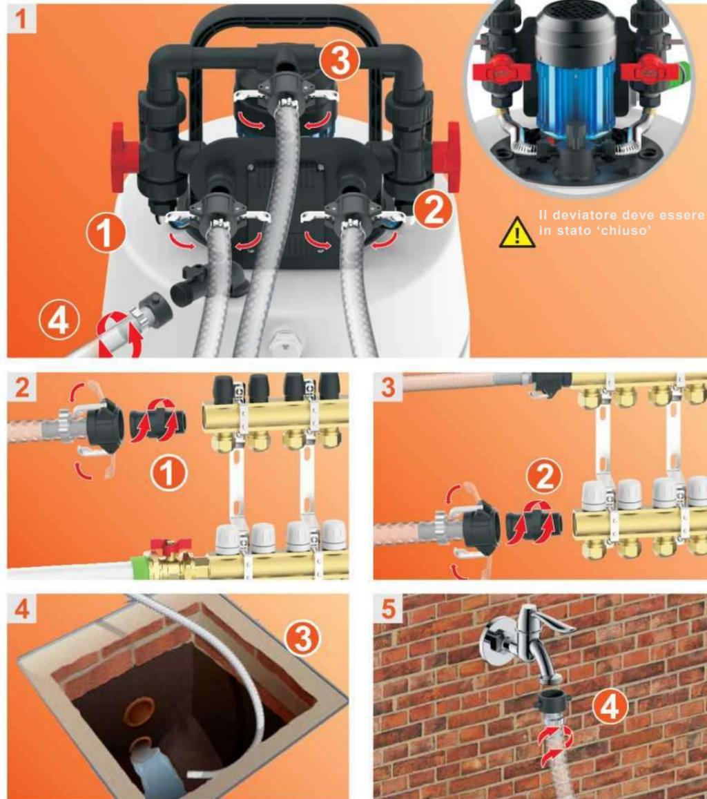
1. Collegare i tubi di circolazione, il tubo di scarico, il tubo di ingresso acqua ai fori indicati della pompa per lavaggio impianti;
