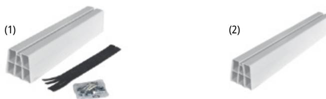
Basi a pavimento per il supporto di unità esterne complete di dadi e di fissaggi. Ancoraggio e adattamento al pavimento tramite fasce adesive (modello 1) o tramite guarnizioni stampate (modello 2).
