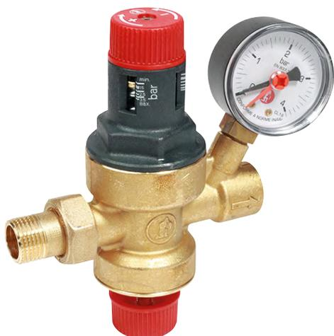
Gruppo di riempimento automatico per installazione sulla tubazione di adduzione dell'acqua negli impianti di riscaldamento/raffrescamento a circuito chiuso. Cartuccia e filtro estraibili per facilitare le operazioni di pulizia e manutenzione. Funzione anticalcare e funzione di regolazione della pressione con sede compensata.
