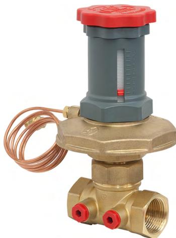
La valvola di bilanciamento R206C è un regolatore di pressione differenziale e serve a mantenere il valore della pressione differenziale costante su una parte del circuito idraulico, indipendentemente dalla portata.
