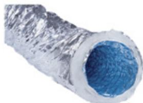
Tubazione flessibile in fogli di alluminio/ poliestere multistrato, supportato da un filo di acciaio armonico inserito tra due strati di alluminio saldati a caldo, con materassino termoisolante in fibra di poliestere (spessore 25 mm, densità 14 kg/m<sup>3</sup>, protezione anticondensa in alluminio/poliestere).
