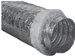
Tubazione flessibile con parete in laminato di alluminio micro-forato per l'attenuazione del livello sonoro, armatura a spirale in filo di acciaio armonico incorporata tra due strati, materassino termo-isolante in fibra di poliestere spessore 25 mm, rivestimento esterno in laminato d'alluminio rinforzato;
