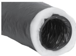
Tubazione flessibile con parete in PVC, armatura a spirale in filo di acciaio armonico incorporata tra due strati termosaldati, materassino isolante in fibra di poliestere spessore 25 mm, rivestimento esterno in foglia di resina polioefinica;
