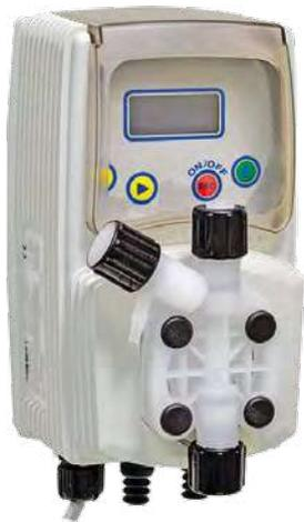
Pompa dosatrice multifunzione con Display LCD IP65, con sonda di livello (evita la marcia a secco) per pescaggio diretto da tanica, valvola di iniezione, valvola di fondo/filtro, tubo aspirazione/mandata/scarico aria.
