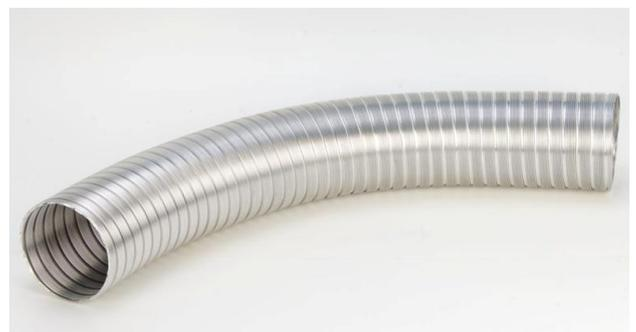
Condotto metallico flessibile a doppia struttura corrugato esterno e liscio interno a sezione circolare in acciaio inox AISI 316L di spessore 0,10+0,10 mm (0,12+0,12mm per il DN300), completo di raccordi al monoparete rigido Mitico Mono e Conix Mono CON e SENZA manicotto silconico di tenuta. Per il raccordo tra flex e rigido in caso di funzionamento ad umido il condotto è dotato anche di appositi raccordi anticondensa.
