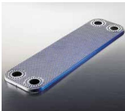
In ragione di una distribuzione del fluido più uniforme, le Micro Plate™ utilizzano meglio la superficie di scambio, generando la massima turbolenza e migliorando l'efficienza complessiva dell'impianto. Al contrario dei vecchi modelli, il rapporto tra aree con flussi più veloci e aree con flussi più lenti è minimo (solo x 3, invece di x 10), una differenza che consente di migliorare la distribuzione del fluido, massimizzando il trasferimento del calore.
