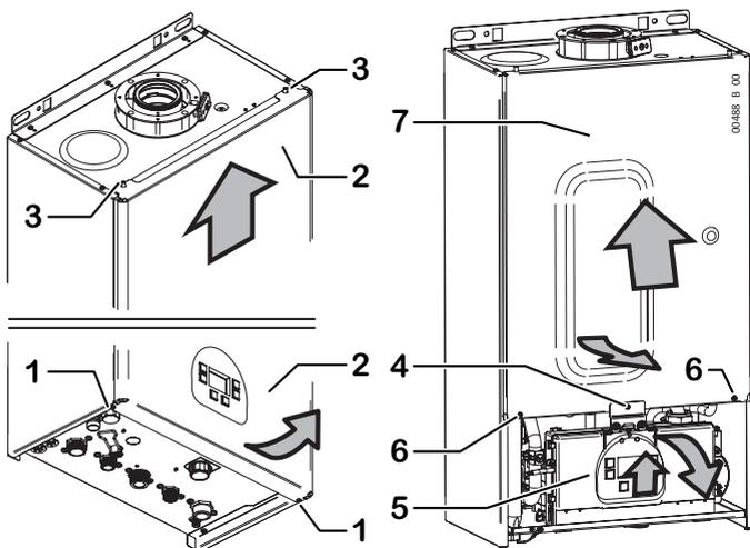
5. una volta eseguite le operazioni che richiedono l'accesso ai componenti interni, chiudere la caldaia eseguendo le operazioni in senso inverso, curando la chiusura a tenuta della camera stagna.
