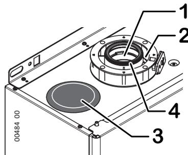
**(i)** Prima di installare l'accessorio di partenza fumisteria (scarico fumi o attacco aspirazione+scarico coassiale) **controllare la presenza ed il corretto posizionamento della guarnizione 4.**
