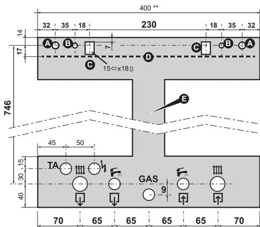
**Nota:** È disponibile separatamente l'apposita dima riutilizzabile in metallo (E in figura) che agevola il posizionamento degli attacchi (utilizzando il Kit Raccordi originale) e dei punti di fissaggio direttamente in opera. Se non si utilizzano la dima in metallo e/o il Kit Raccordi originale, vedere la posizione degli attacchi idraulici della caldaia nel paragrafo "Dimensioni e attacchi" a pagina 14.
