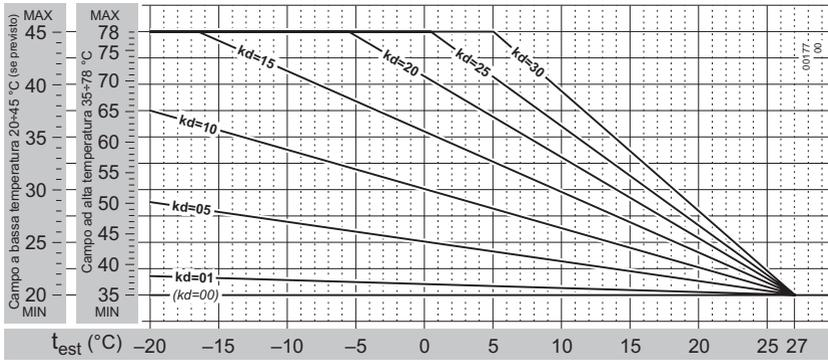
**In pratica, il valore di  $kd$  va regolato in funzione della qualità stimata dell'isolamento termico dell'immobile. Il suo campo di regolazione sarà da 01 a 30: i valori più alti si utilizzano quando vi è un'alta dispersione termica e quindi un isolamento meno efficiente (e vice versa).**
