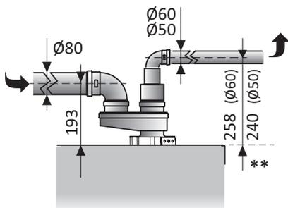
L'altezza dell'asse del condotto orizzontale\*\* dipende dalla presenza del riduttore (da Ø80mm a 60 o 50mm) e dal suo posizionamento:
