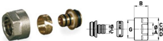
Raccordo a compressione per tubo in polietilene multistrato PEX-AL-PEX con filetto da 3/4" eurokonus. Tutte le superfici interne sono prive di trattamenti galvanici, ciò rende il raccordo conforme al D.M. 174 per il trasporto di acqua potabile.
