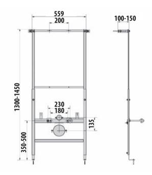
Applicazione: Installazione ad incasso per vaso sospeso in pareti di muratura.
