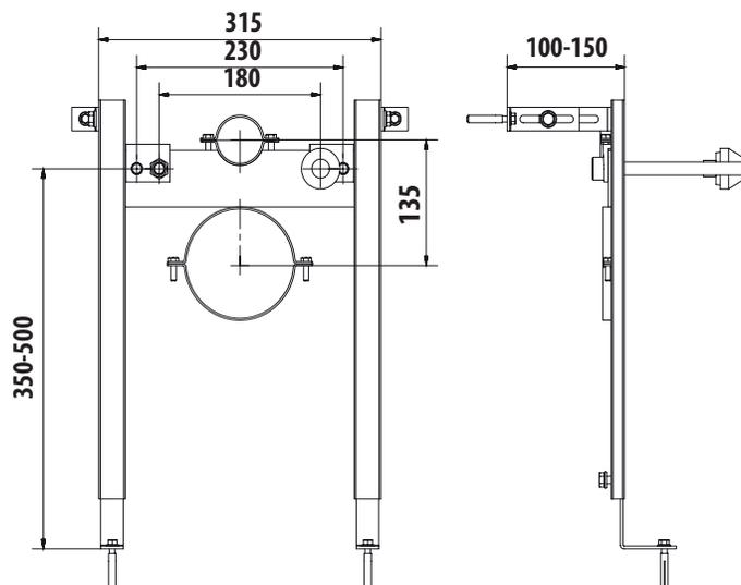
**Applicazione:** Installazione ad incasso per vaso sospeso in pareti di muratura.
