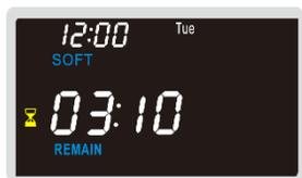
Per SOF3, sul display si alternano i valori di capacità residua dell'acqua e di tempo residuo fino a quando uno dei due non raggiunge lo zero.
