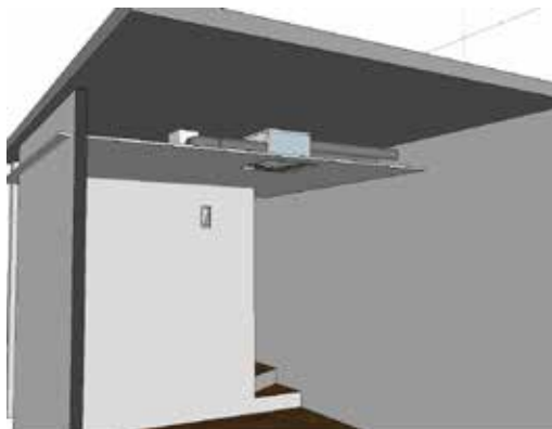
Installazione in controsoffitto
