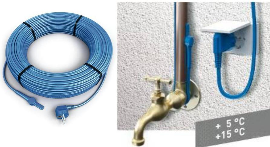
Soluzione ideale per risolvere il problema del congelamento delle tubazioni. È un cavo a potenza costante, pronto all'uso con termostato tarato per l'inserimento a 5°C e lo stacco a 15°C, 2 metri di cavo freddo e spina per il collegamento.
