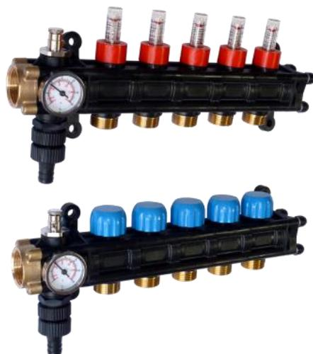
Collettore modulare compatto per sistemi di riscaldamento/raffrescamento a pavimento, realizzato in tecnopolimero. E' il primo collettore per impianti radianti che può essere alloggiato in una cassetta a tenuta stagna con profondità 8 cm. La particolare struttura dei moduli permette ridotte perdite di carico anche in presenza di molti circuiti.
