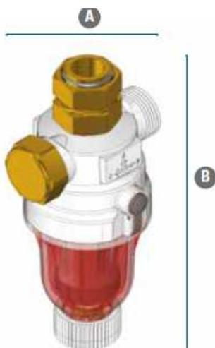
Mini defangatore filtro magnetico multi attacco in linea e a squadra con codolo tappo per installazioni facili, rapide e salvaspazio (in meno di 6 cm di interasse per una altezza massima di 15 cm) sotto le caldaie a condensazione. È installabile sia in verticale (installazione consigliata per la massima efficienza) che in orizzontale.
