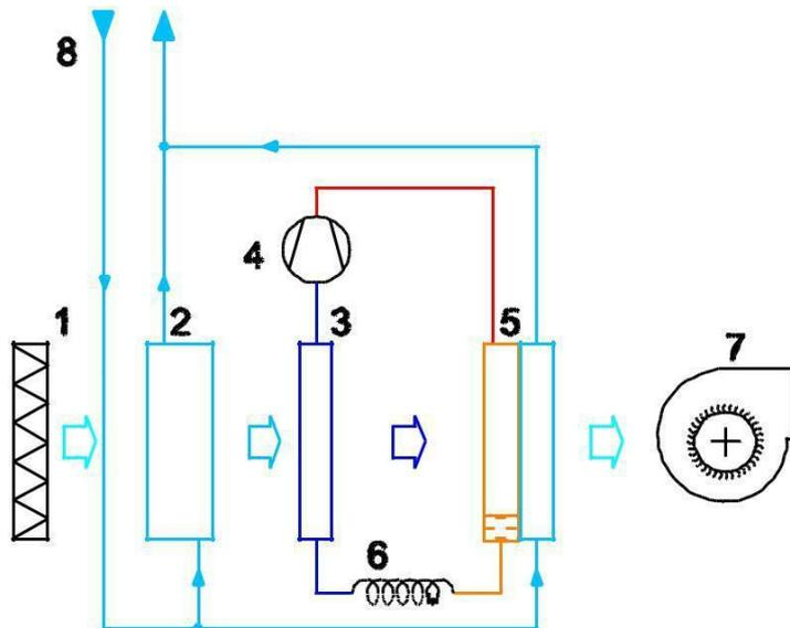
Fig. 1 Schema del deumidificatore ENERGY E24
