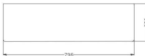
Il mobiletto va fissato alla parete, ad una altezza consigliata di 15-20 cm dal pavimento. Per il fissaggio vanno utilizzati i fori  $\varnothing=5\text{mm}$  presenti sulle quattro squadrette metalliche all'interno della cornice.
