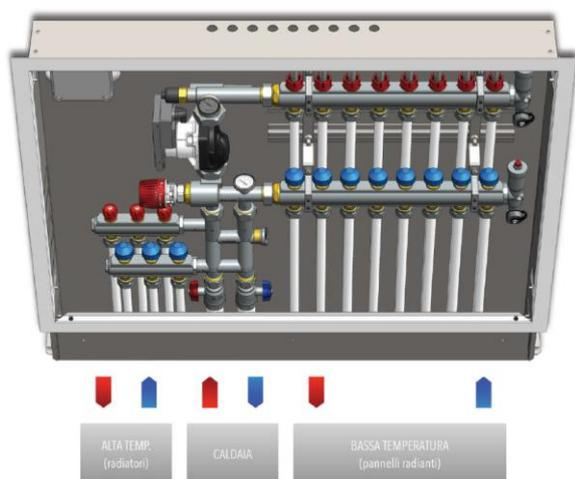
La circolazione dell'acqua nei pannelli radianti del circuito secondario è attivata tramite la pompa di rilancio, mentre la valvola di regolazione mantiene costante la temperatura dell'acqua da inviare ai pannelli radianti agendo sulla quantità d'acqua ad alta temperatura da integrare al circuito secondario.
