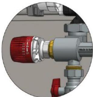
La testa termostatica regola la temperatura dell'acqua di andata nel circuito in bassa temperatura. per impostare la temperatura, ruotare la testa fino al valore desiderato:
