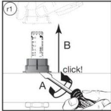
Il valore della portata teorica di un circuito idraulico, stabilito dal tecnico, è determinato dalla regolazione effettuata tramite i flussimetri posizionati sul collettore di mandata.
