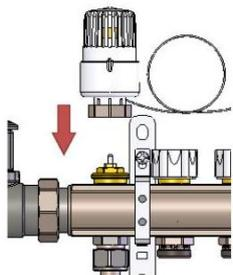
Installazione della testa termostatica per punto fisso:
