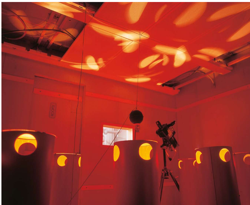
Fig. 4.1 Laboratori Giacomini: particolare della camera termostatica a Norma EN 14240
