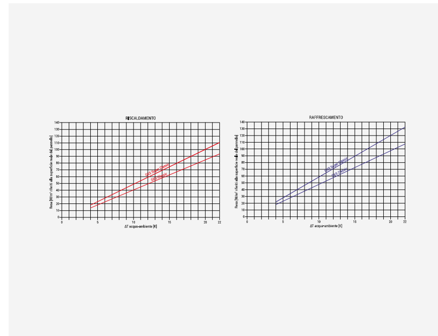
Fig. 4,9 Rese secondo prove in camera termostatica. Le rese sono riferite alla superficie reale del pannello.
