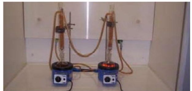
Fig. 2 Bagno di prova secondo UNI EN 579
