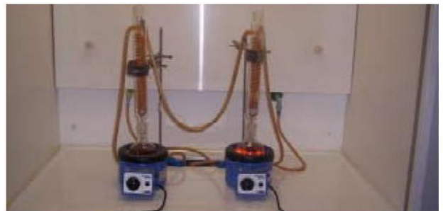
Fig. 2 Bagno di prova secondo UNI EN 579
