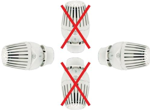
Le teste termostatiche devono essere installate in posizione orizzontale. Per non falsare la rilevazione della temperatura, le teste termostatiche non devono essere installate in nicchie, cassonetti, dietro tendaggi o essere esposte direttamente ai raggi solari.
