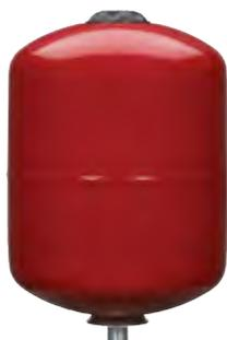
Vasi di espansione per impianti di riscaldamento, a membrana fissa, flangia in acciaio al carbonio zincata, pressione di precarica 1,5 bar, temperatura -10 +99 °C, colore rosso
