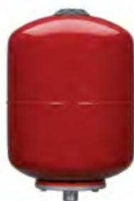
Vasi di espansione linea sollevamento verticali, vasi idrici multifunzione verticali, membrana sostituibile, flangia in acciaio zincato o verniciato, colore rosso, pressione di precarica 2 bar, temperatura -10 +99 °C
