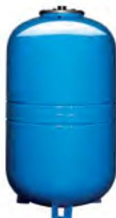
Vasi di espansione multifunzione, per impiego in impianti di riscaldamento, bollitori, elettropompe, acqua calda sanitaria, anti colpo d'ariete. Flangia in acciaio inox, colore blu, membrana sostituibile, flangia avvitata, pressione di precarica 2 bar, temperatura -10 +99 °C
