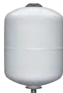
Vasi di espansione a membrana fissa per acqua sanitaria calda e fredda, riscaldamento, bollitori, anti colpo d'ariete, elettropompe, flangia in acciaio inox, precarica 3,5 bar, temperatura -10 +99 °C.
