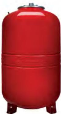
Vasi di espansione per impianti di riscaldamento, a membrana intercambiabile dal modello 50 litri. Flangia in acciaio zincato per i modelli fino a 400l, verniciata per i modelli 500÷1000. Attacco superiore da 35 a 700 litri - inferiore per modello 1000 litri, pressione di precarica 1,5 bar, temperatura -10 +99 °C, colore rosso
